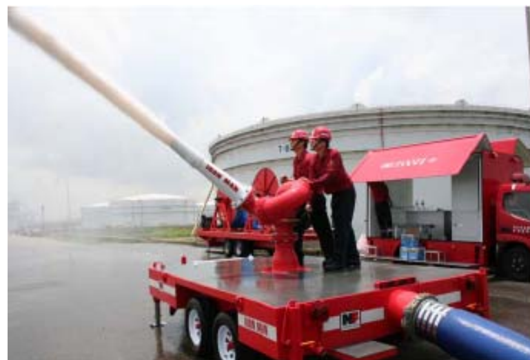
大容量泡放射砲放射実験風景 (イメージ)
