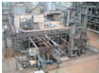
液化炭酸製造装置 製油所から排出される炭酸ガスを回収・精製して液化炭酸を製造します。
