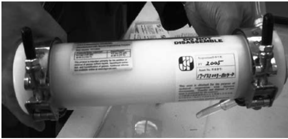
図3 実験用メンブレン・コンタクターの例
