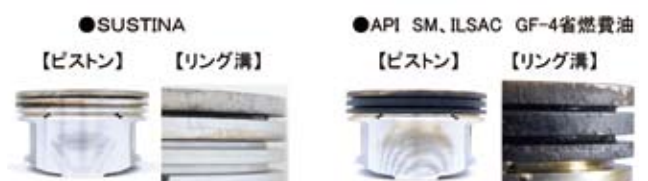
図15 高温エンジン試験後のピストン
