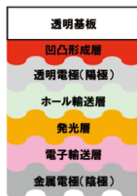
図 2 コルゲート基板を用いた有機 EL 素子の断面模式図
