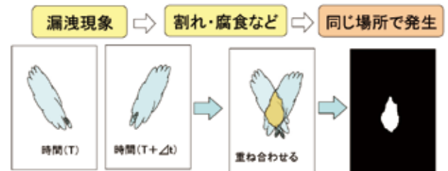
図7 白煙検知手法の原理
