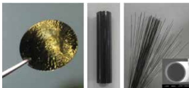
図 2 左から平膜、管状カーボン膜 (外径 10 mm)、中空糸カーボン膜 (外径 0.25 mm)
