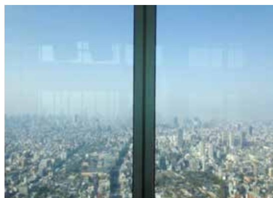
図2 窓ガラスの外観(左:フィルム有り 右:フィルム無し)
