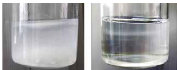
従来触媒 (不均一系：スラリー状) 新触媒 (均一系：溶液状)
