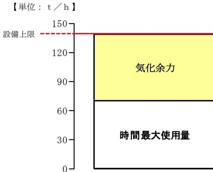
上図は、当社で予定しているピーク日における気化器の時間最大使用量のイメージを示したものです。気化余力は60 t/h（製造計画策定値を基に算出）となりますが、LNGの供給変動、ガスの需要動向、定期検査、予定外設備工事等により変動します。
