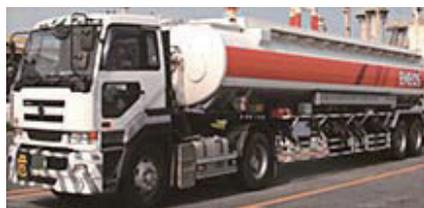
※ 混油防止系统：在设有汽油、轻油等多油种卸货口的服务站等，装载电脑控制系统，在连接卸货软管时，如装货的油罐汽车和卸货槽车的油种不同时，将阻断其卸货。
