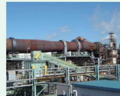
JX金属苦小牧化学株式会社 旋窑式焚烧炉
