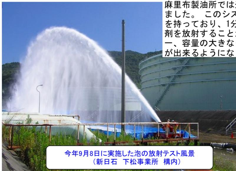
麻里布製油所では近隣の企業と共同でこのシステムを導入しました。このシステムは今までの消火設備の10倍以上の能力を持っており、1分間にドラム缶200本分(40000L)の泡消火薬剤を放射することが出来る国内最大級のシステムです。万が一、容量の大きなタンクが火災になっても、素早く消火活動が出来るようになります。
