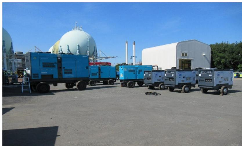
普段倉庫内で保管している移動式非常用発電機、移動式空気圧縮機を搬出し動作確認を実施
