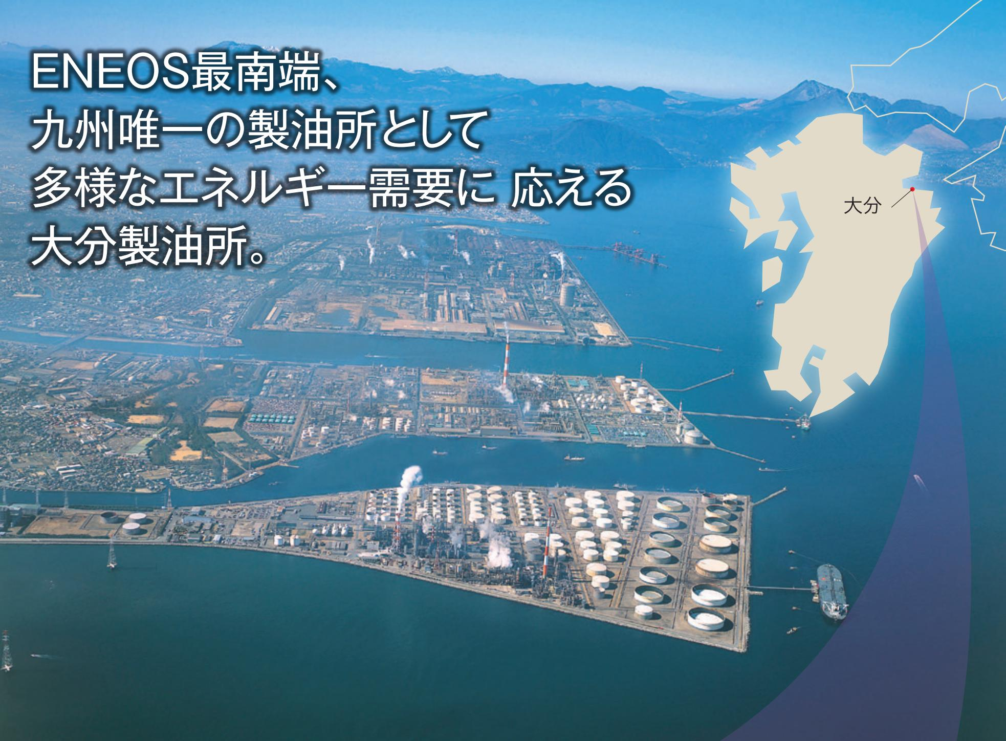
ENEOS最南端の製油所である大分製油所は、「石油精製」「石油化学」「電気事業」の3つの事業を柱に、九州エリアの多様なエネルギー需要をカバーしています。原油処理能力は136,000バーレル/日。LPG、ナフサ、ガソリン、灯油、軽油、重油などの高品質な各種石油製品の製造ならびに安定的な供給に努めるほか、石油化学製品の原料となるキシレン、パラキシレン、ベンゼン、石炭ナフサなどの生産、そして電気事業まで、総合エネルギー企業として、地域のエネルギー需要に貢献しています。また、安全・安定操業のために万全の体制を整え、環境保全対策にも最新の設備と効率的な管理で対応。地域社会との共生に努めています。
