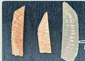
左から、貝を裁断した未加工の貝、両面を薄くした貝、0.08mmまで削って完成した薄貝。薄貝は石川県輪島市、富山県高岡市、和歌山市等へ送られます
