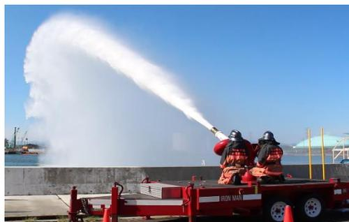
通常の消防車の約10倍の放水量を誇る「大容量泡放射システム」
