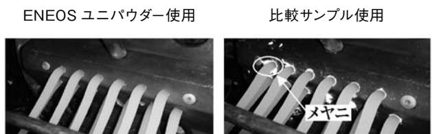
図 6 押出機出口でのメヤニ発生の様子
