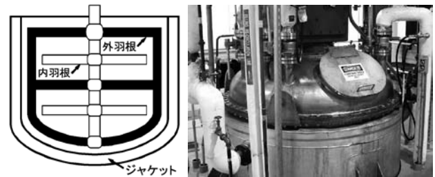
図3 ダブルモーション型反応兼仕上げ釜の模式図と外観
