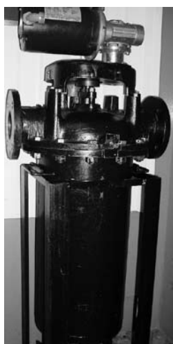
写真3 多層式フィルター
