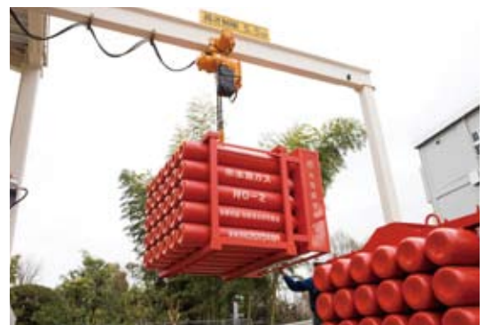
水素カードルの受入れ
