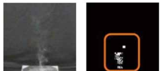
図8 希薄白煙画像(左)と白煙検知手法による処理画像(右)
