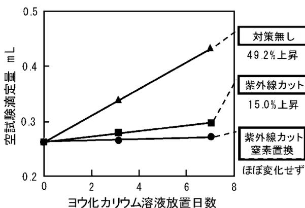
図4 ヨウ化カリウム溶液の劣化比較
