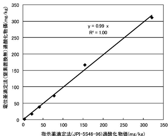
図 2 指示薬滴定法と電位差滴定法との関係—灯油試料<sup>3)</sup>
