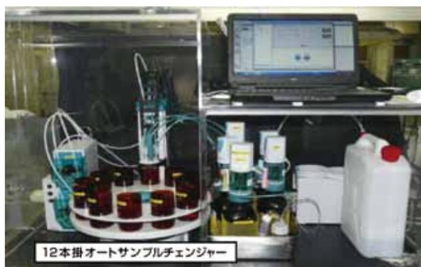
図 3 過酸化物質自動測定装置
