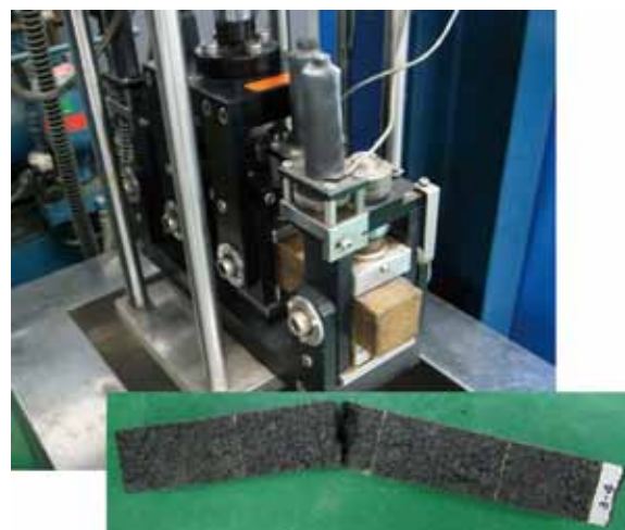
図7 曲げ疲労試験機(上)と供試体(下)
