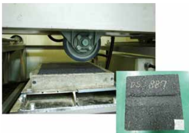
図5 ホイールトラッキング試験機(左上)と供試体(右下)
