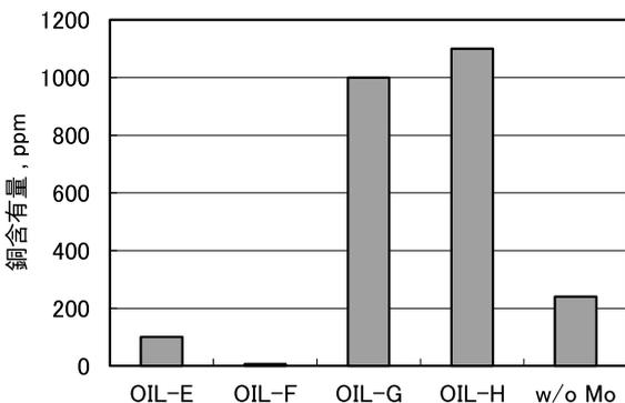
図 9 OIL-E ~ H の ISOT96 時間後の油中銅量
