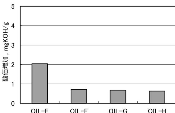
図 6 OIL-E ~ H の NO<sub>x</sub> 吹き込み試験 72 時間後の酸価増加
