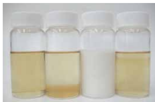
図 3 水溶性加工油の溶解テスト (左から、NS220M、NS200、蒸留水、準水系洗浄剤)
