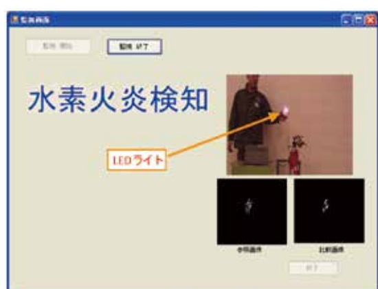
図5 模擬水素火炎装置による検知実験
