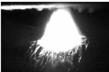
図10 マルチフィラメントの振動 緑色レーザー光での観察
