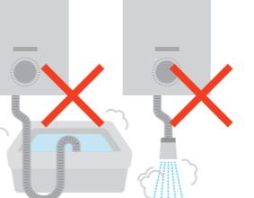
小型湯沸器での浴槽への給湯、洗髪などの長時間の連続使用は不完全燃焼を起こし、一酸化炭素を発生させる可能性があるため大変危険です。
