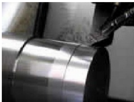
極微量の油で金属加工を行うMQL加工
