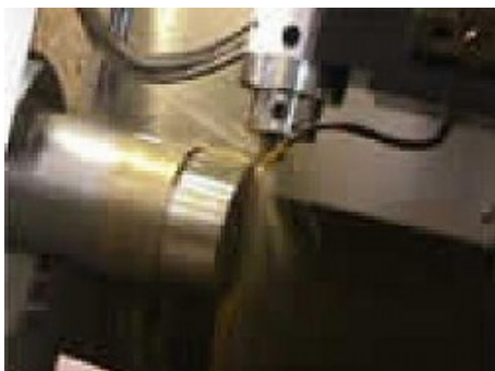
大量の切削油を用いた従来の金属加工
