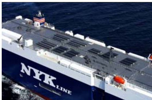
太陽光パネル搭載船「アウリガ・リーダー」
