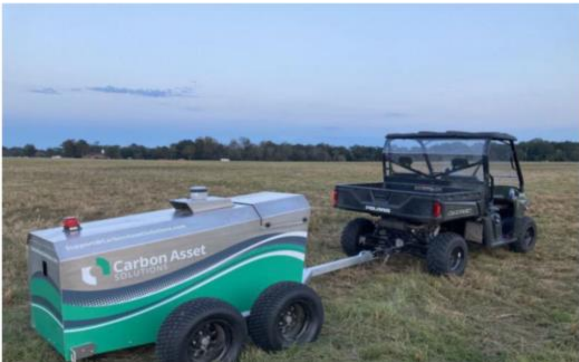
※2：CASが独占ライセンスを保有するMINS法*による土壤炭素測定の様子
