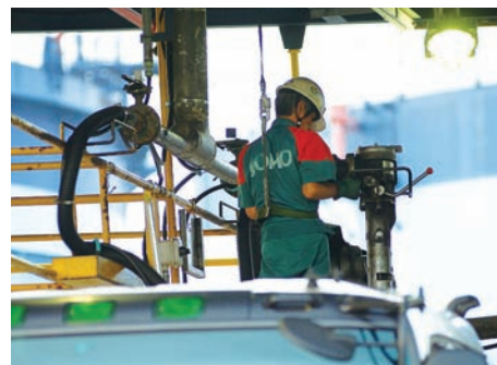
使用安全带给油罐车进行充填作业。
