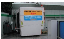
洗车水再利用型洗车机
