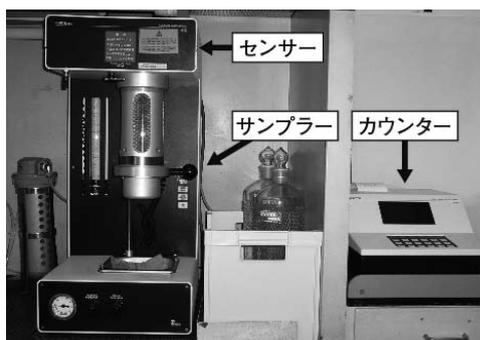
図 4 自動微粒子計数器の外観
