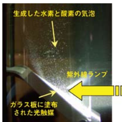
図 3 NiO/NaTaO_3:La 光触媒を用いた高効率な水分解
