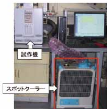
図 8 オープン冷却システム
