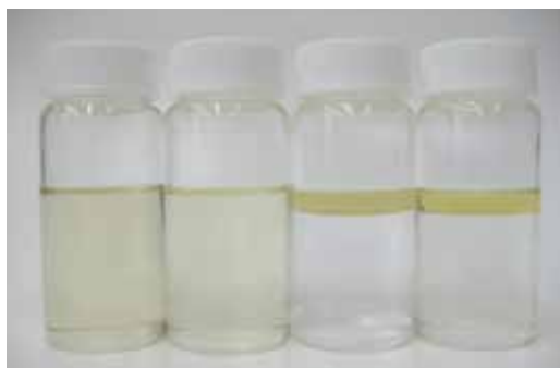
図 2 不水溶性加工油の溶解テスト (左から、NS220M、NS200、蒸留水、準水系洗浄剤)
