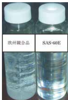
写真5 低温保存試験後の絶縁油
