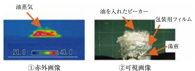
図6 軽質ガソリン蒸気の撮影結果
