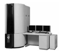
写真 1 走査透過電子顕微鏡の外観 (株)日立ハイテクノロジーズ製 HD-2700
