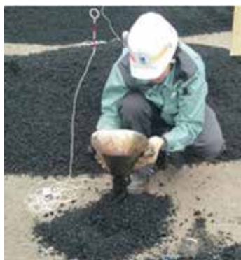
図8 フロー試験の様子(敷均しやすさ)
