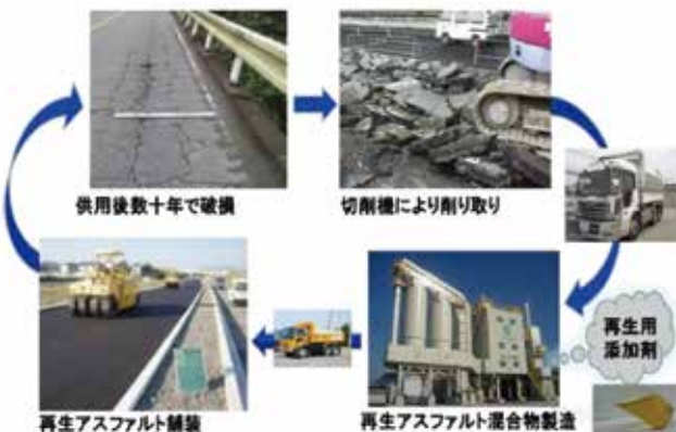
図1 循環型舗装システム
