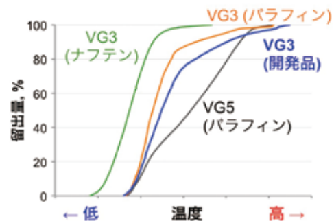
図4 従来基油と開発基油における留出温度の比較
