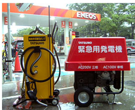
緊急用可搬式ポンプ(左)と緊急用発電機(右)
